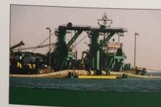
Le tronçon MARITIME, descend vers le sud sur 11 km en contournant les zones rocheuses riches en flore et en faune, jusqu'aux fonds de 30 m au large. Pour éviter toute corrosion, il est constitué d'éléments en PEHD (polyéthylène haute densité).
